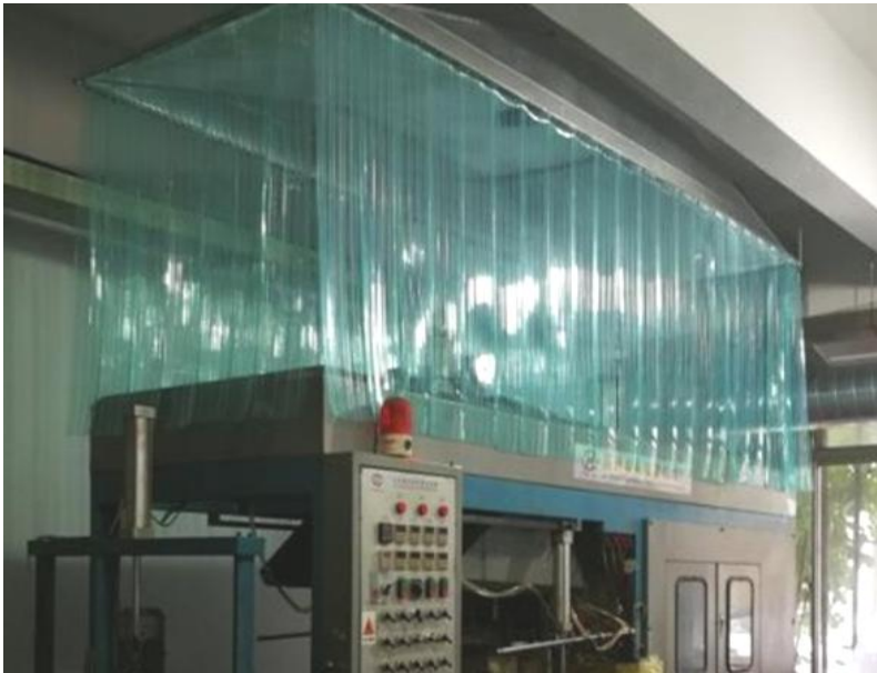
图4.1 包围型集气罩（含软帘）示例图片
