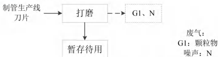
图2-3 刀具维修工艺流程图
