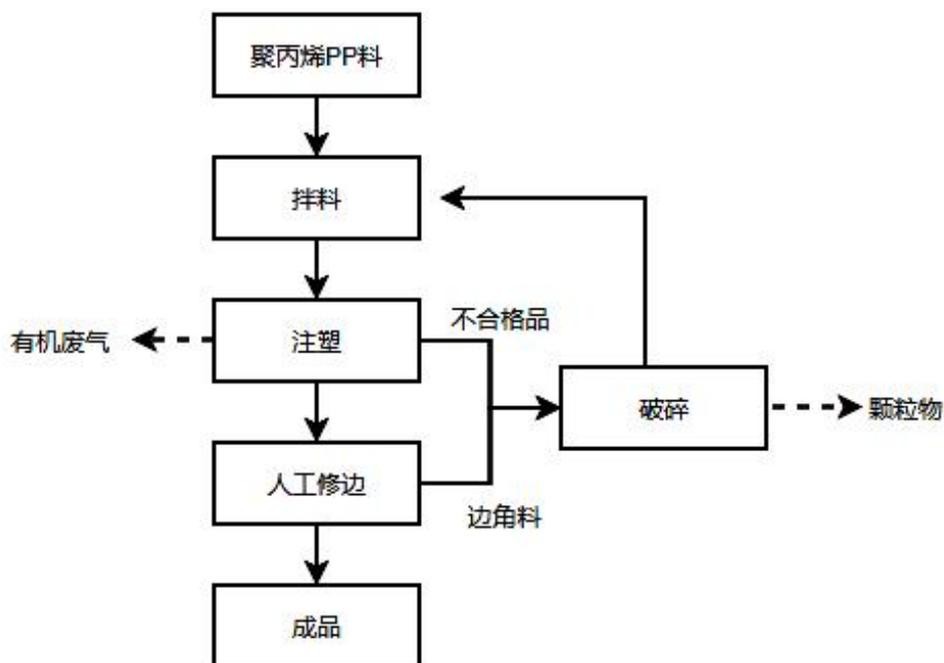
图2项目注塑工艺流程图
