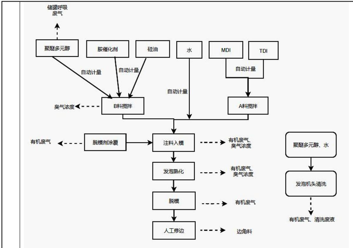
图 3 本项目发泡工艺流程图
