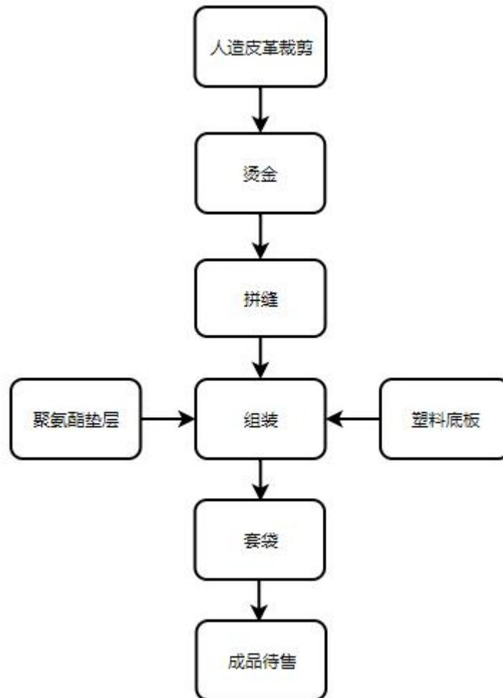
图4 项目组装塑工艺流程图
