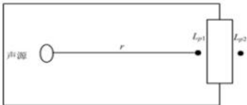
图 10 室内声源等效为室外声源图例
