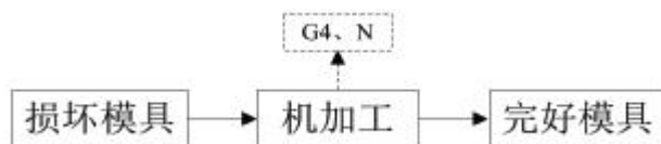
图 2-7 项目模具维修工艺流程图
