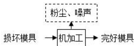
图 2-6 项目模具维修工艺流程图
