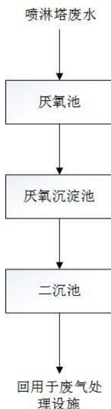
图 4-1 废水处理工艺流程图
