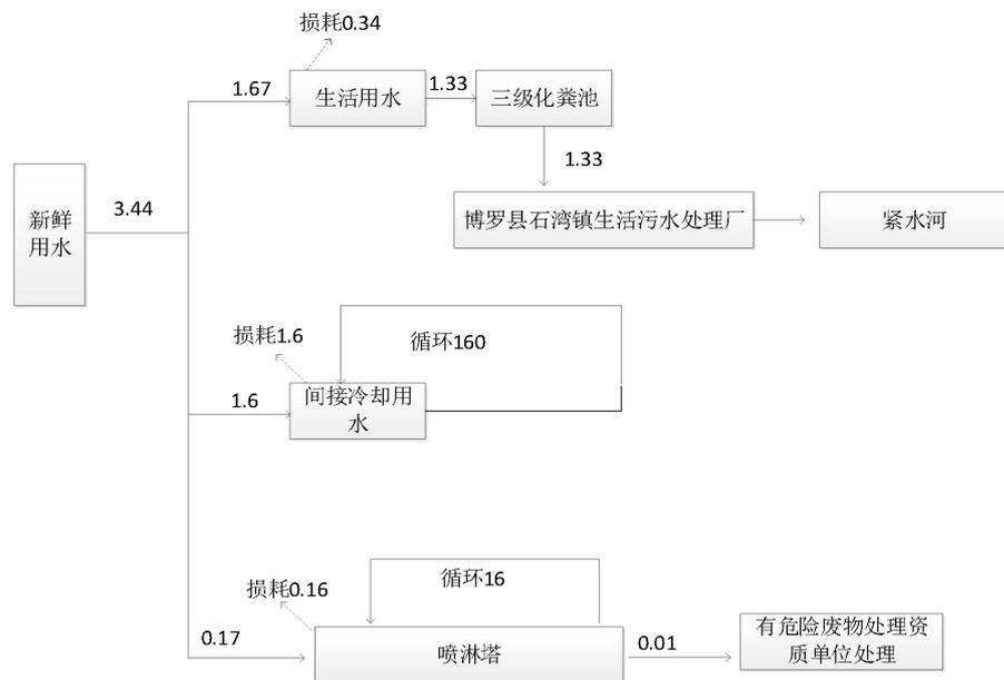
图 2-1 项目水平衡图 单位：m<sup>3</sup>/d
