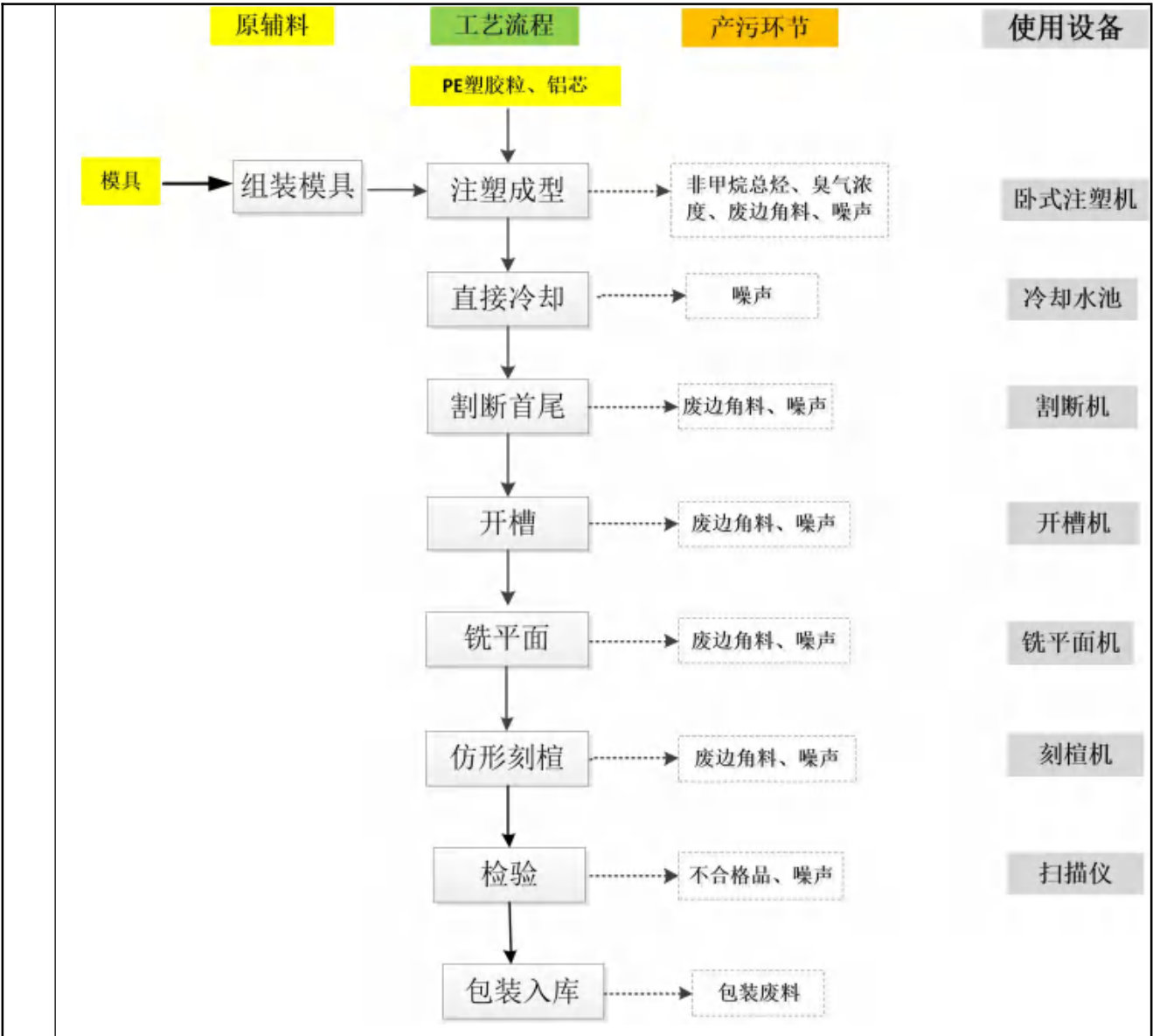
图 3 项目鞋榫生产工艺流程图及产污节点图
