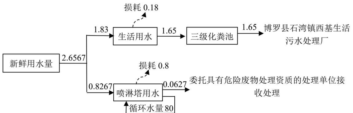
图 2-1 项目水平衡图 单位 t/d
