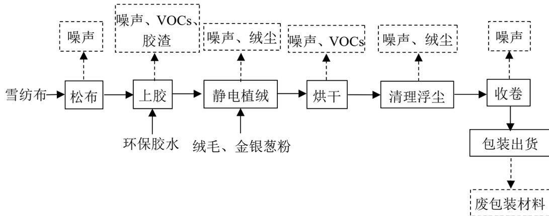
图 2-2 产品生产工艺流程图
