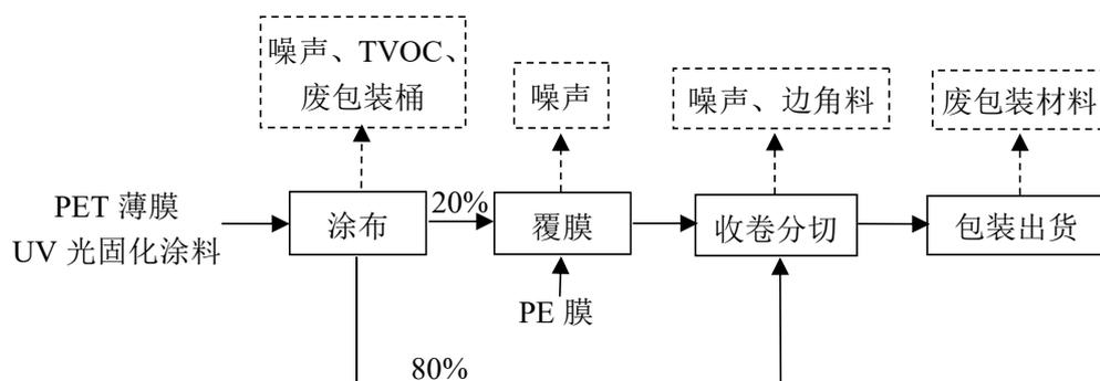
图 2-2 产品生产工艺流程图
