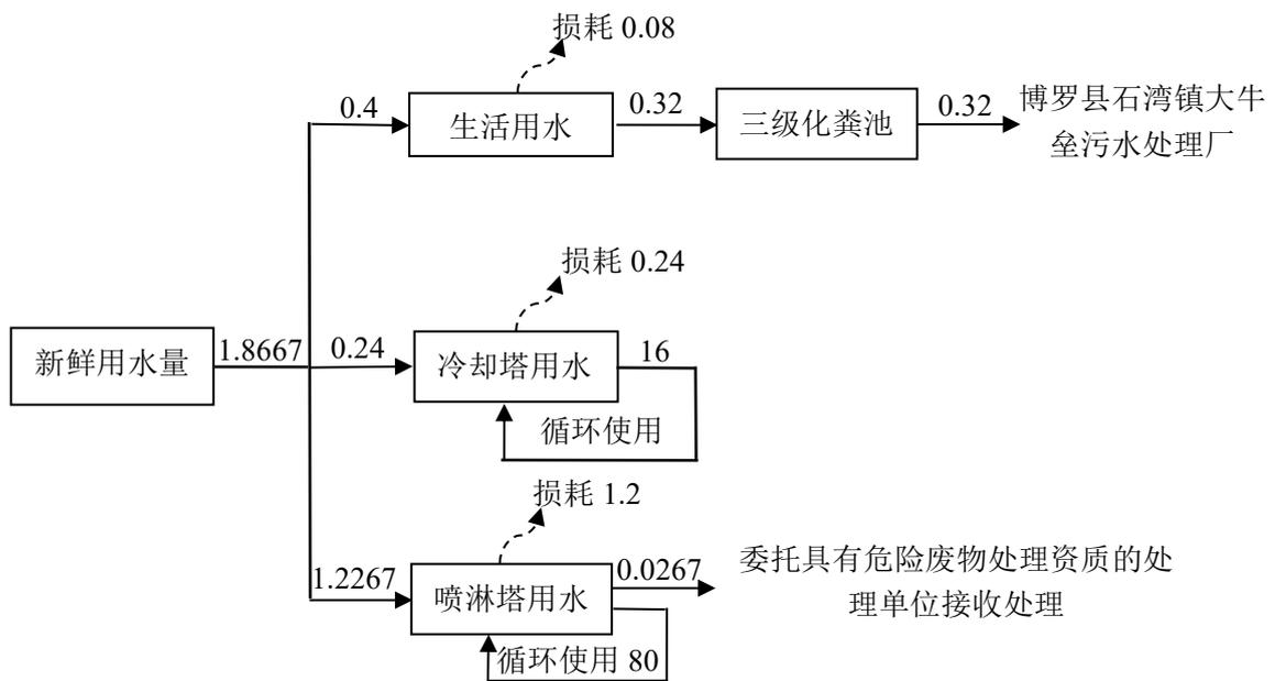
图 2-1 项目水平衡图 单位 t/d
