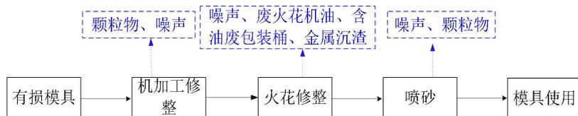
图6 生产工艺及产污环节图
