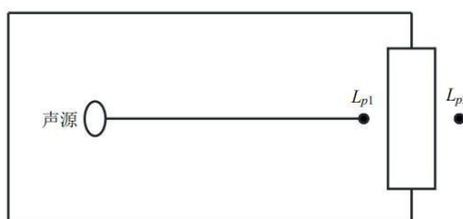
图 8 室内声源等效为室外声源图例
