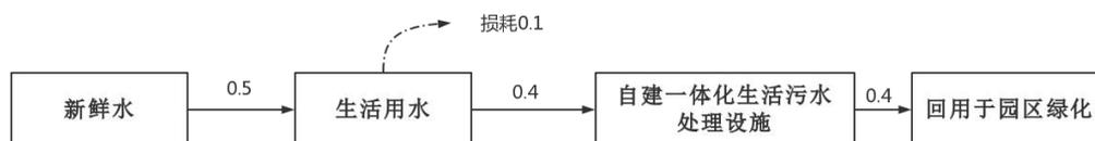
图 1-2 项目近期水平衡图 (非雨季) (单位: t/d)
