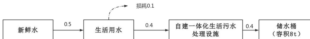
图 1-3 项目近期水平衡图 (雨季) (单位: t/d)
