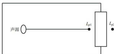
图8 室内声源等效为室外声源图例
