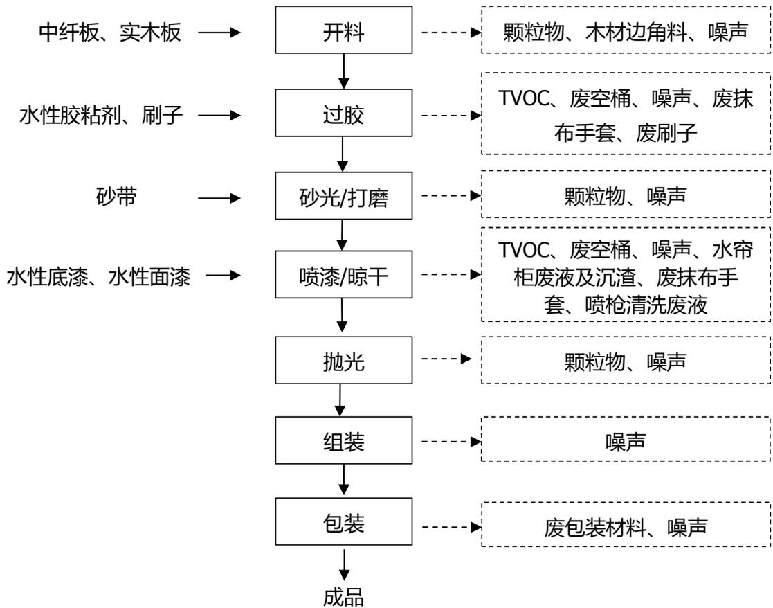
图 2-2 项目生产工艺流程图
