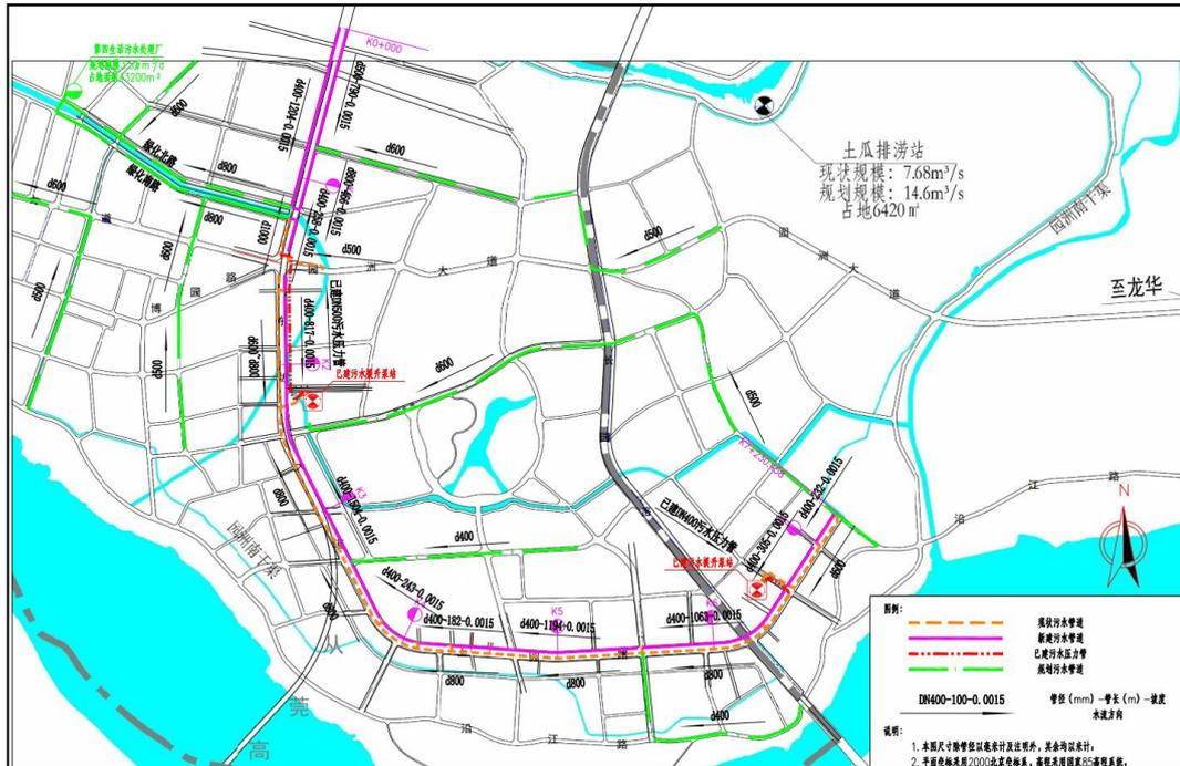
图 2-7 污水管道总平面布置图
