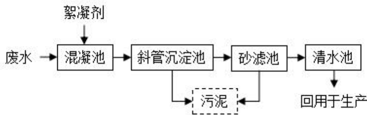
图 4-1 废水处理设施工艺流程图
