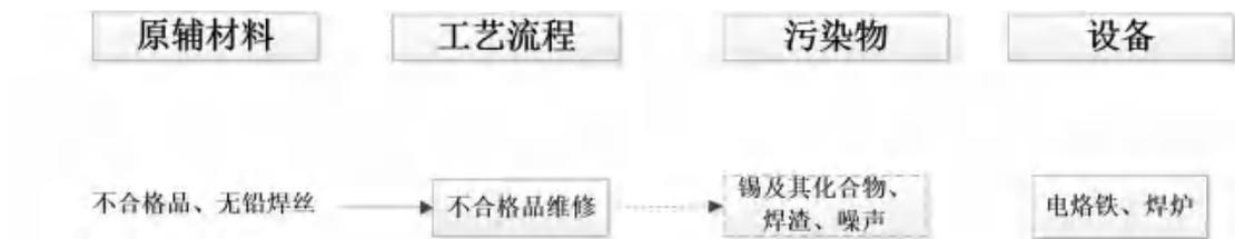
图 2-6 项目不合格品维修生产工艺流程图
