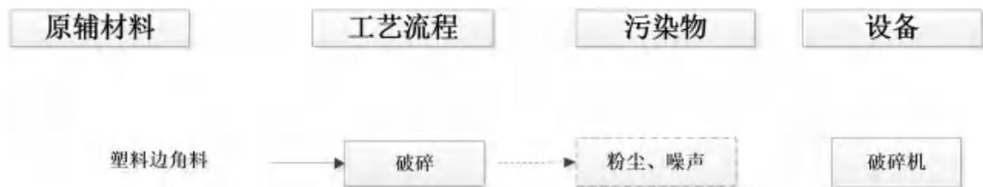
图 2-5 项目塑料边角料破碎生产工艺流程图
