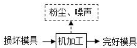
图 2-3 项目模具维修工艺流程及产污环节图
