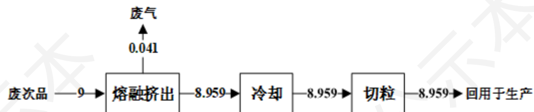
图 2-3 项目废次品回收造粒生产线物料平衡图
