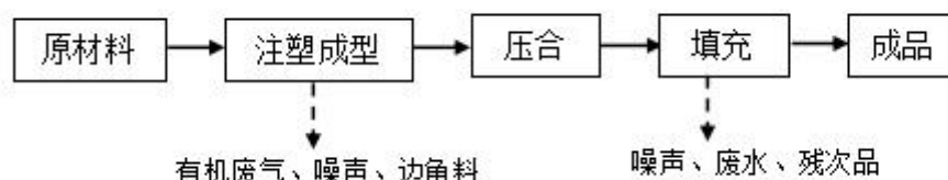
图 4 原有项目苹果手机外壳工艺流程图
