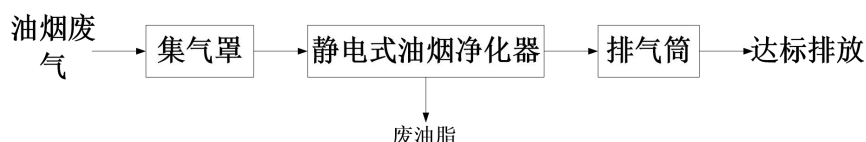
图 4-2 静电式油烟净化器流程图
