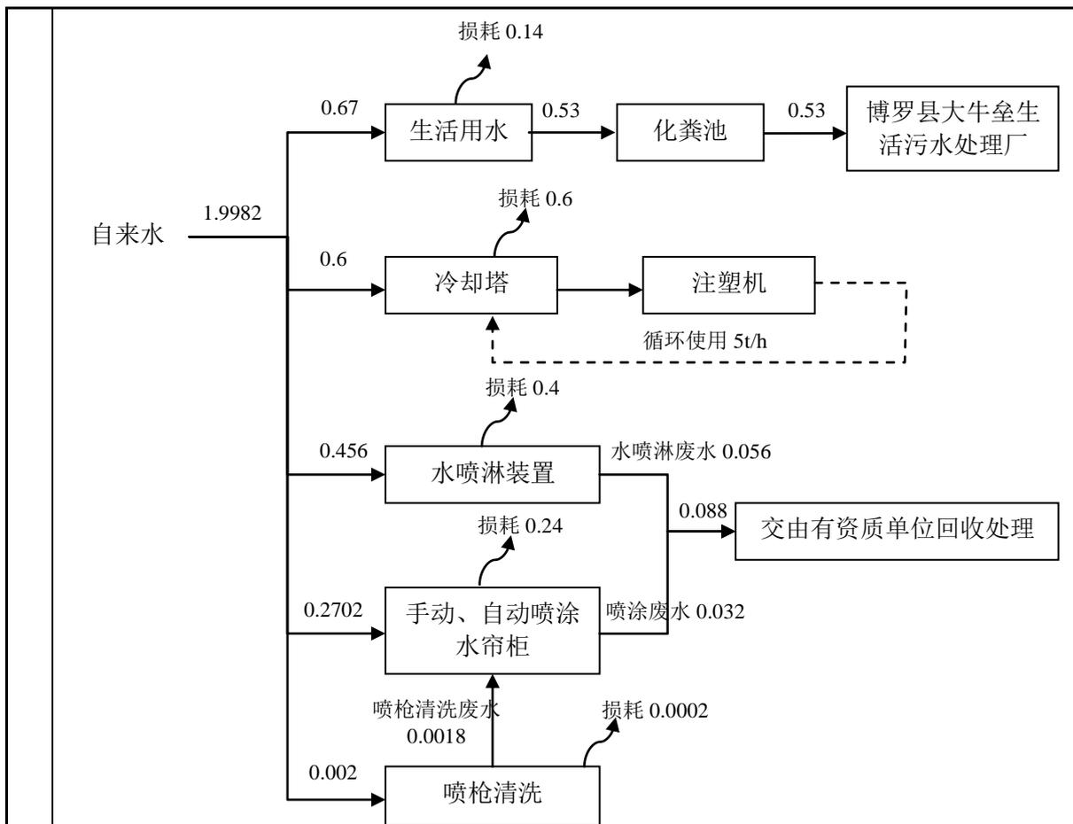
图 1 项目水平衡图 (t/d)
