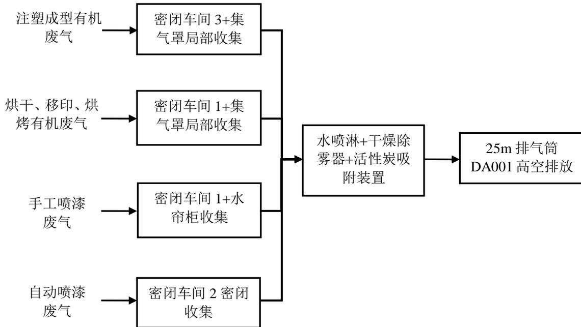
图 4 项目废气处理工艺流程图
