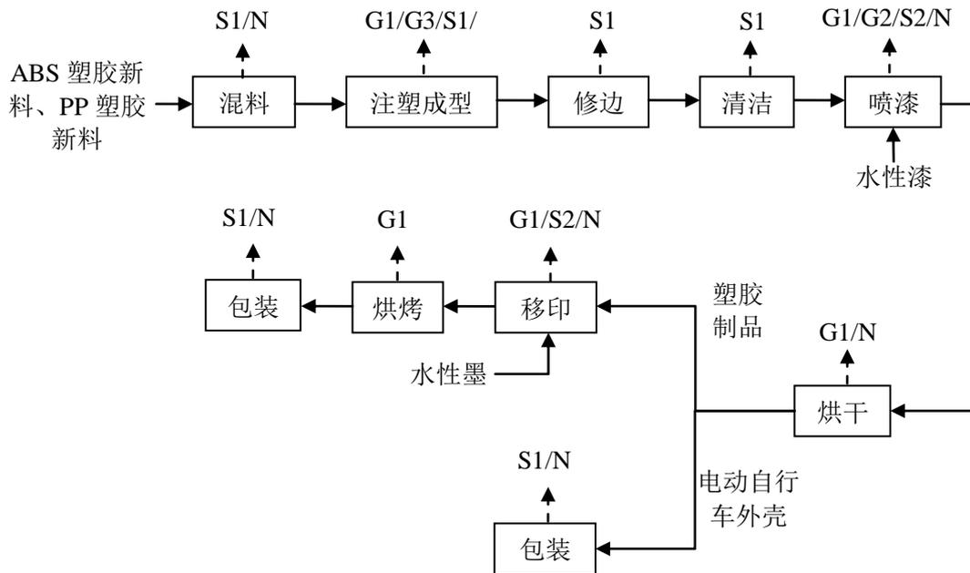
图 2 塑料制品、电动自行车外壳生产工艺及产污环节流程示意图
