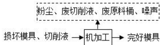
图 2-5 项目模具维修工艺流程图
