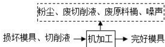
图 2-7 现有项目模具维修工艺流程图
