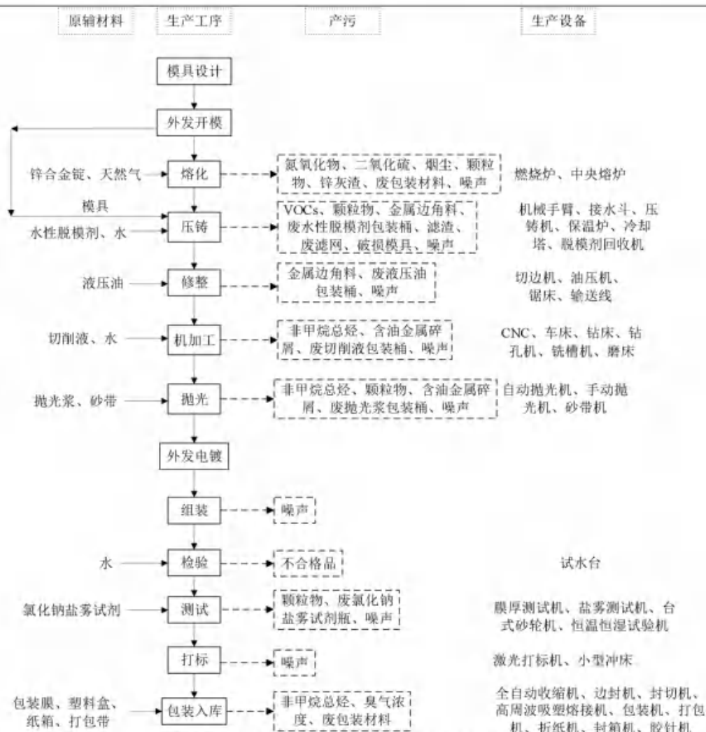
图 2-2 锌合金材质卫浴水龙头、卫浴五金配件生产工艺流程图
