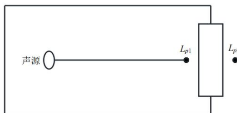
图 4-2 室内声源等效为室外声源图例
