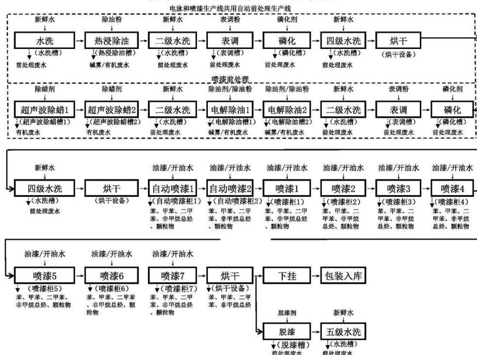
图 2-14 喷漆生产线生产工艺流程
