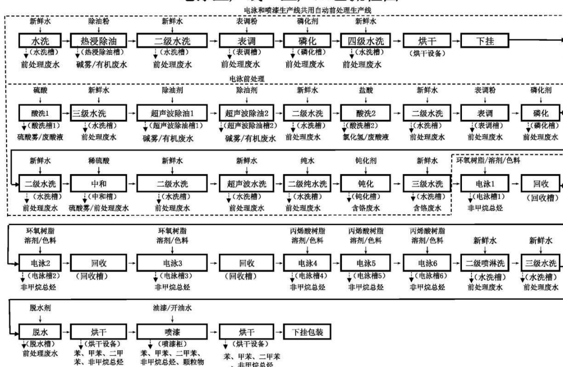
图 2-13 电泳生产线生产工艺流程
