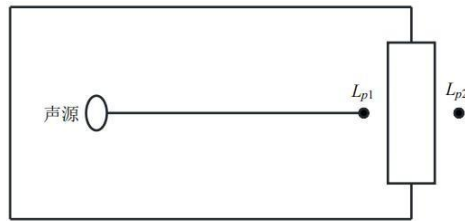
图 4-1 室内声源等效为室外声源图例
