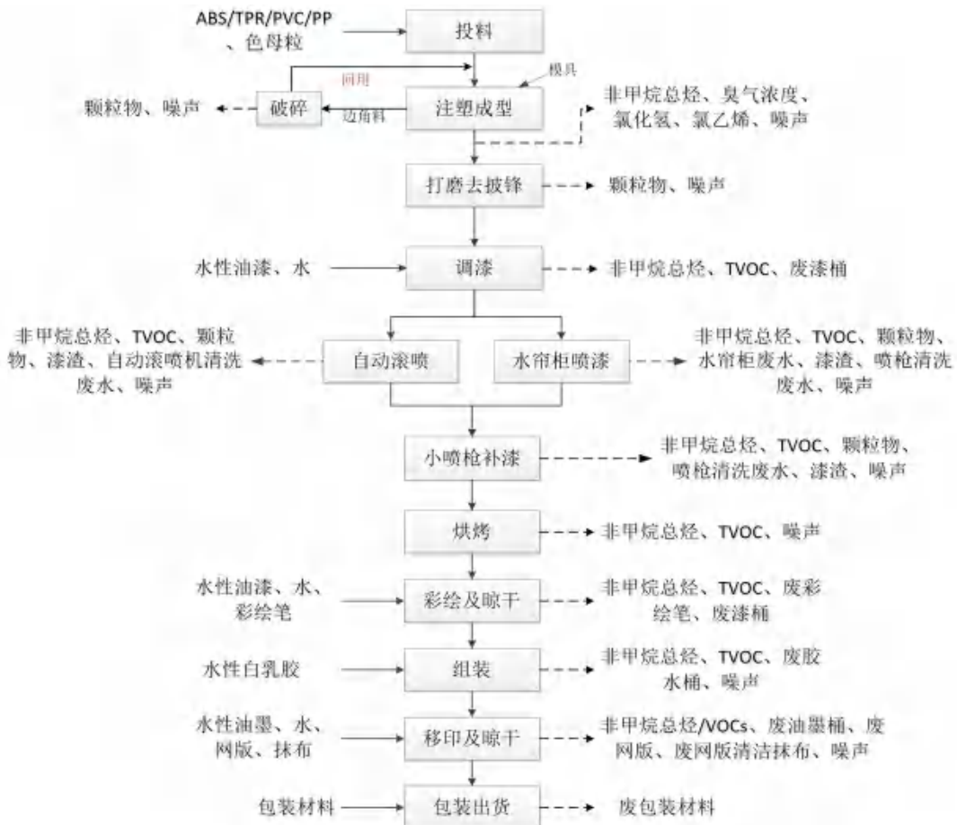
图2 塑胶玩具生产工艺流程图
