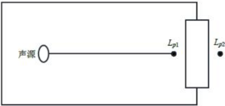
图 5 室内声源等效为室外声源图例
