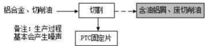
图 2-4 (c) 本项目 PTC 固定片生产工艺流程及产污环节图
