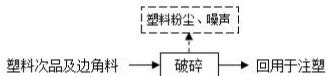
图 2-5 项目破碎工艺流程及产污环节图
