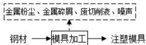
图 2-6 项目自制模具工艺流程及产污环节图
