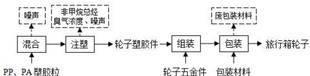
图 2-3 项目旅行箱轮子生产工艺流程及产污环节图
