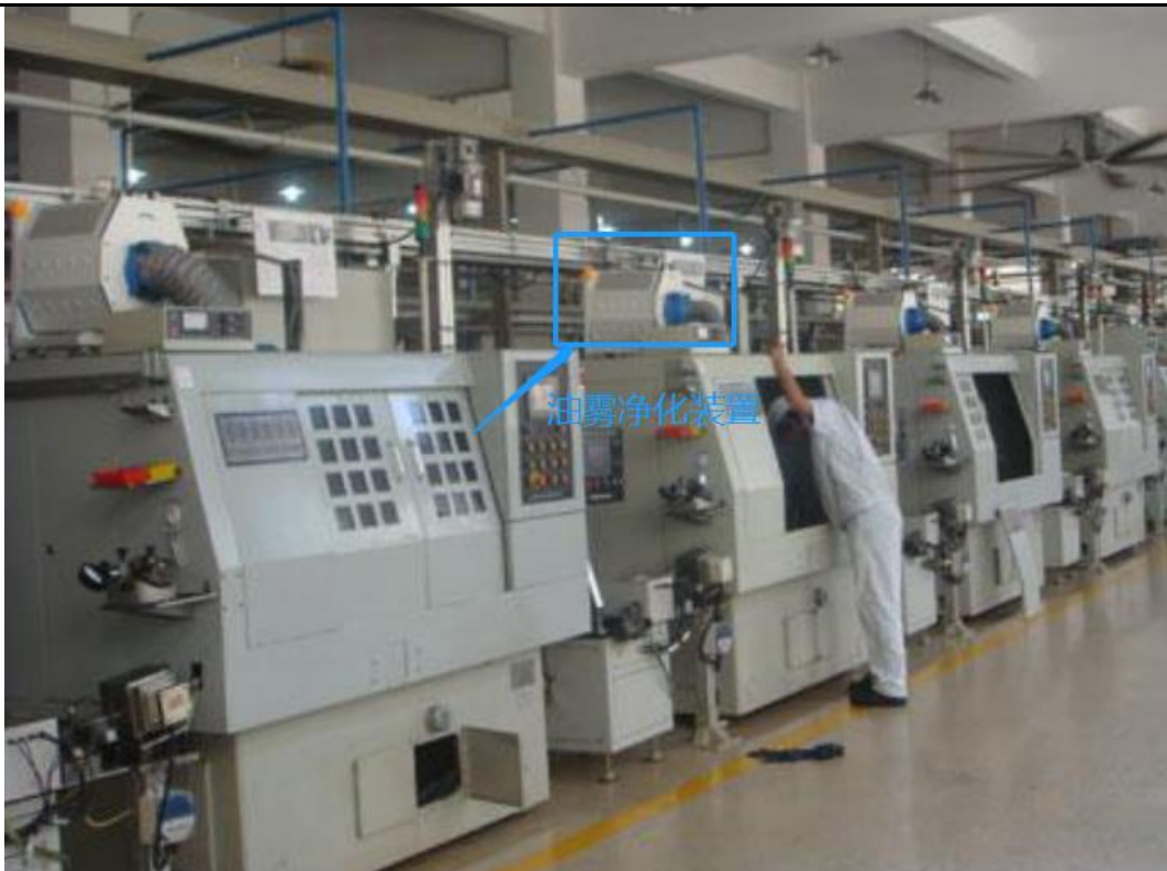
图 4-1 CNC 油雾废气收集处理示意图
