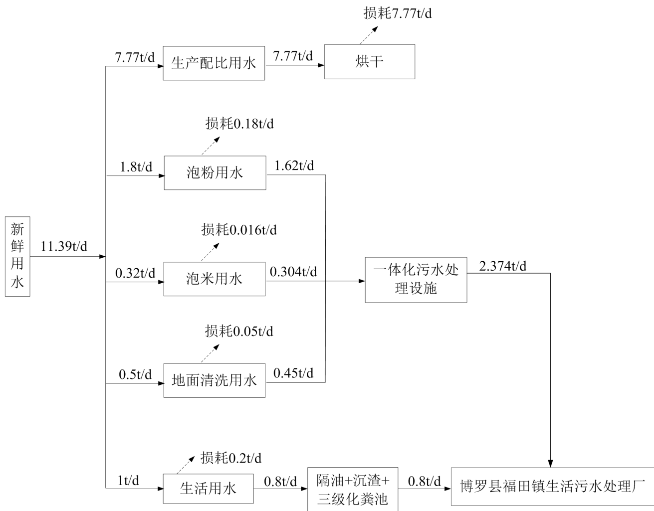
图 1 项目水平衡图（单位：t/d）
