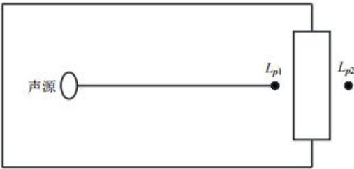
室内声源等效为室外声源图例
