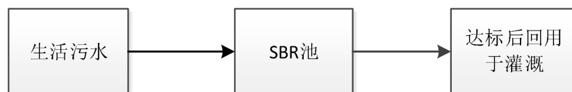
图 4-1 污水处理工艺流程图
