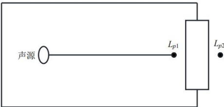
图 4-2 室内声源等效为室外声源图例
