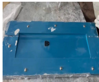
模具（机身模具和机翼模具）
