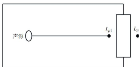
图 4-2 室内声源等效为室外声源图例
