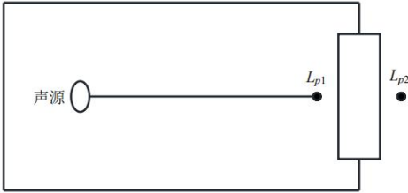
图 4-2 室内声源等效为室外声源图例
