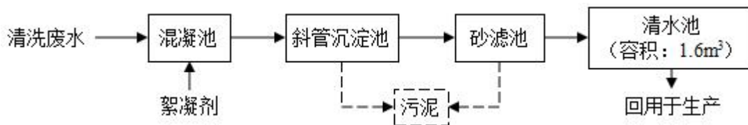
图 4-1 废水处理设施工艺流程图
