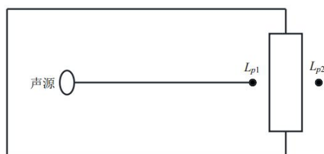
图 4-2 室内声源等效为室外声源图例
