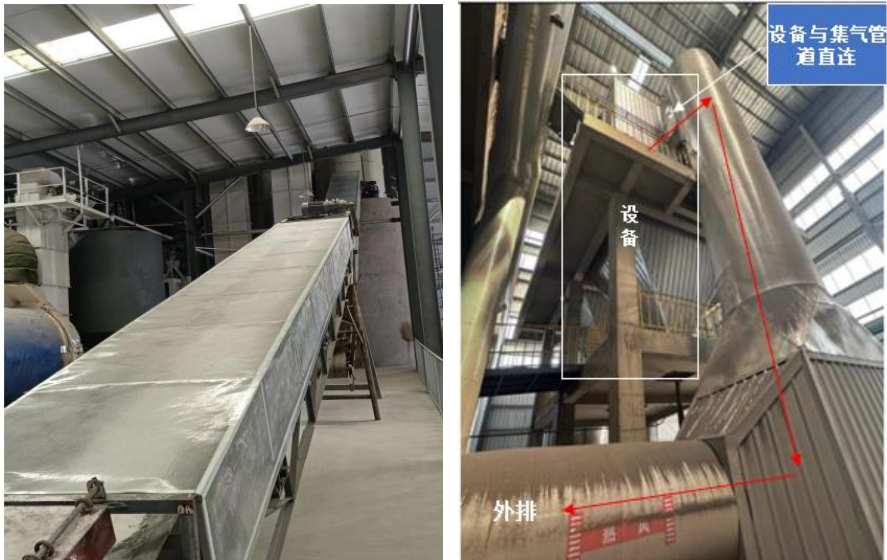
图 4-1 参考拟设置同类项目密封传送带及密闭设备排气口效果图
