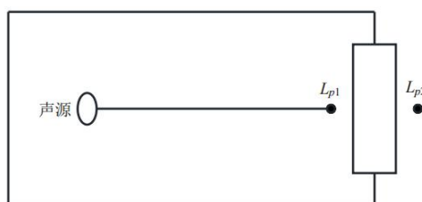
图 4-2 室内声源等效为室外声源图例
