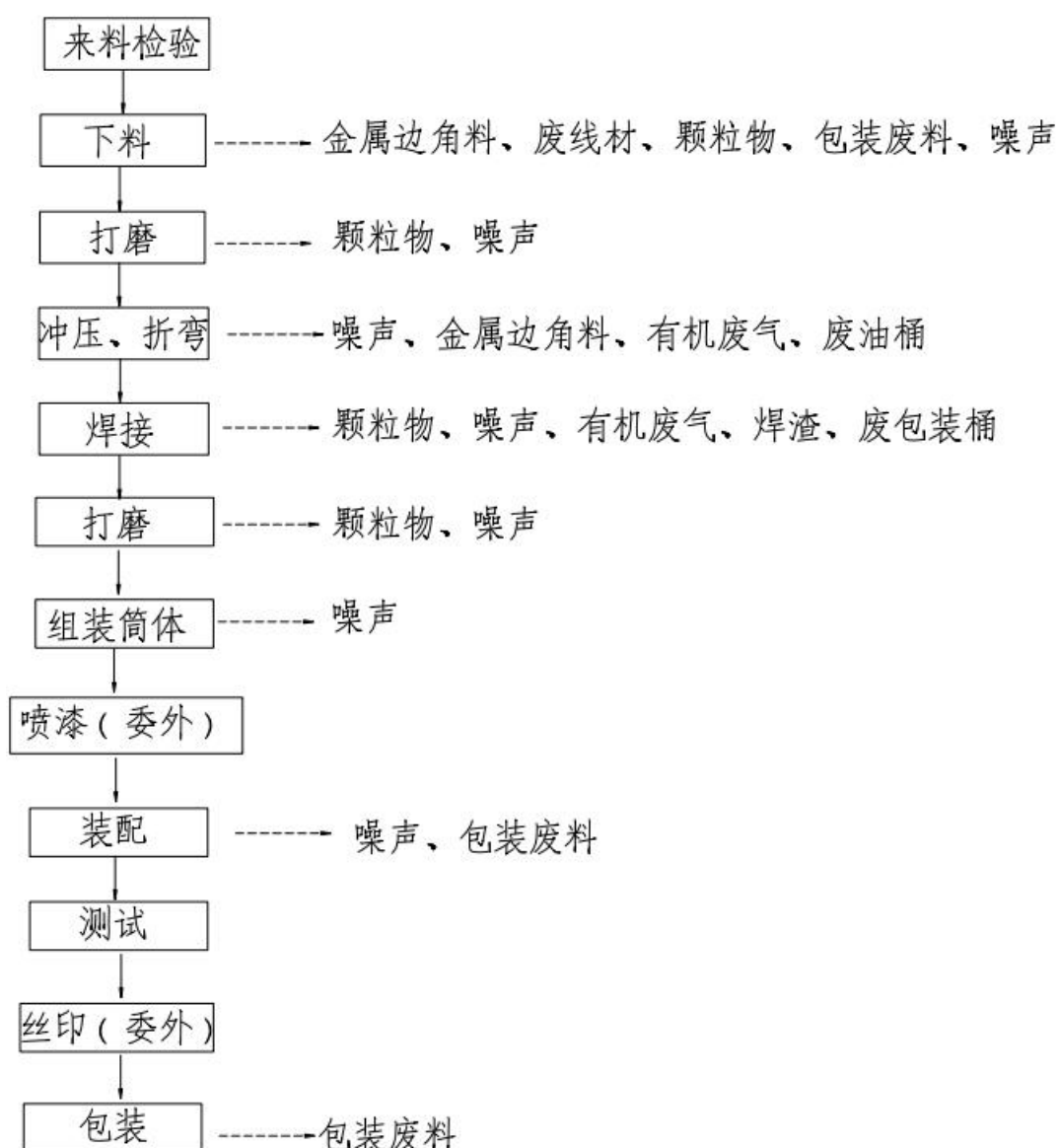
图 2-11 吸附式干燥机、制氧机、制氮机工艺流程及产污环节示意图
