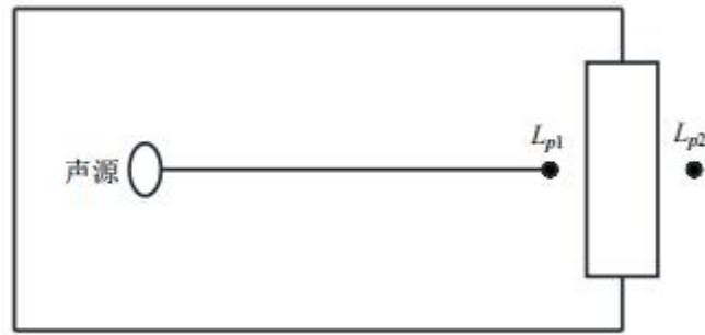
图4-2 室内声源等效为室外声源图例
