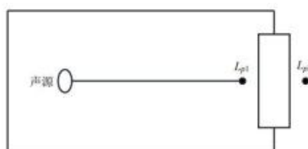
图 4-1 室内声源等效为室外声源图例
