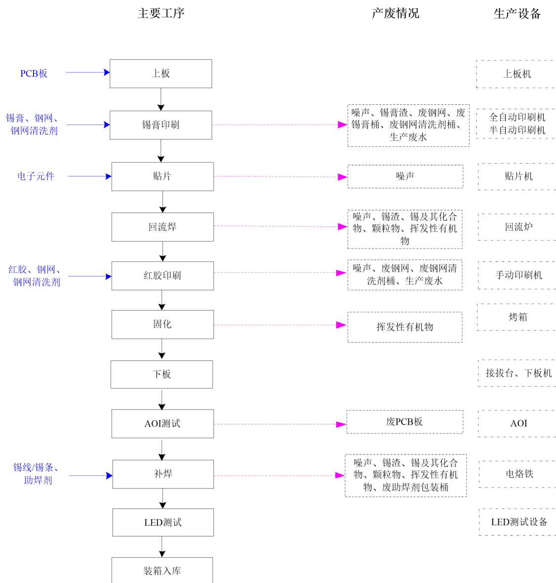
图 2-2 PCBA 生产工艺流程及产排污节点图
