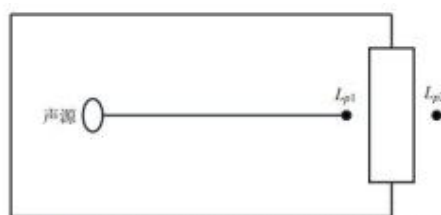
图 4-1 室内声源等效为室外声源图例
