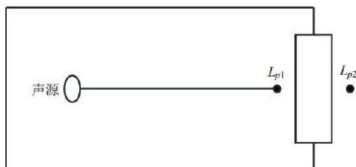
图 4-1 室内声源等效为室外声源图例
