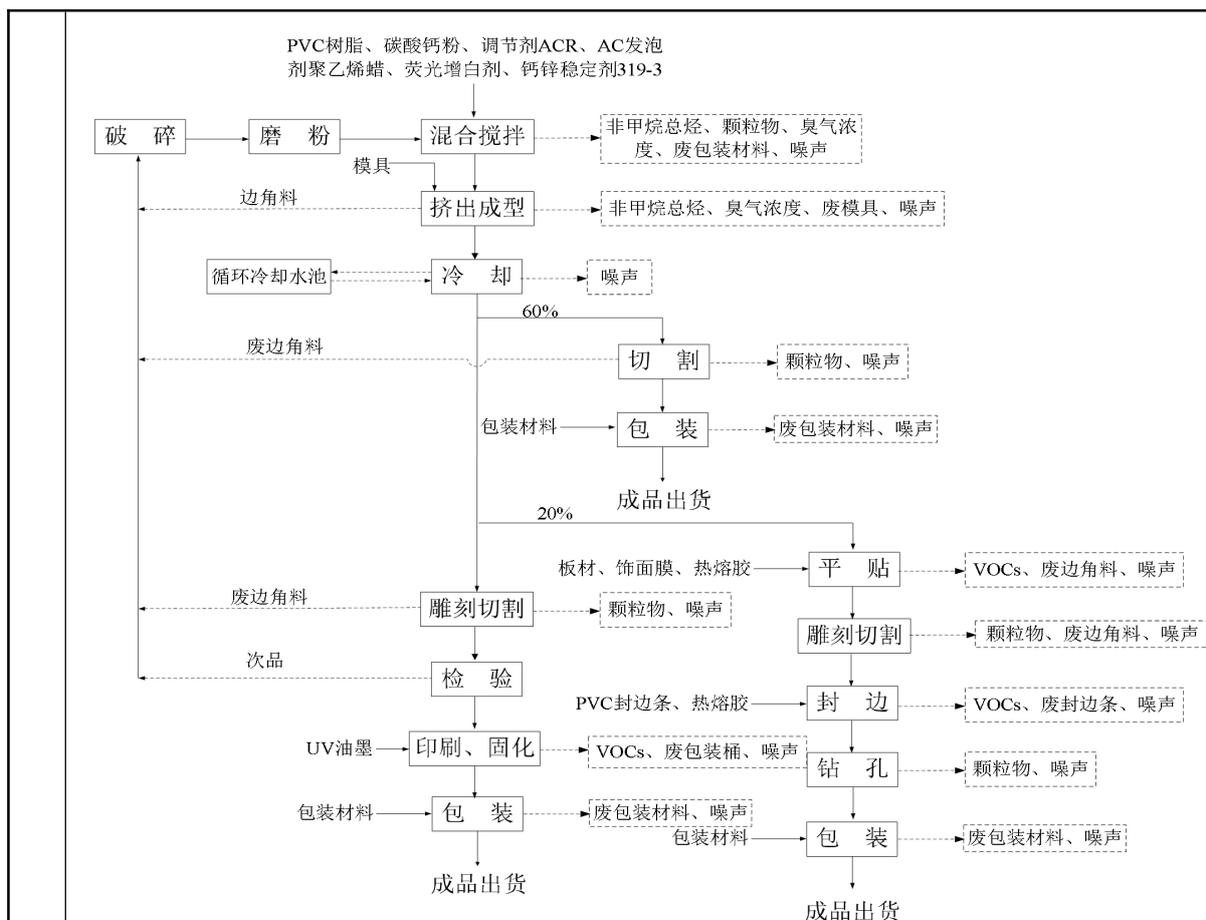
**图 2 PVC 发泡板生产工艺流程图及产污环节**
